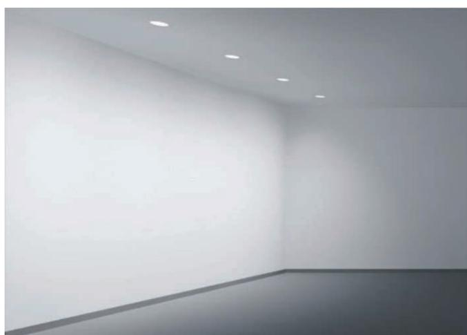
强调统一墙体亮度分布，体现天花板到地面的墙体利益，使用波浪滤镜造就拉长光线的变异，这是一种高均匀性的洗墙方式；适合在博物馆照明、墙体浮雕照明、建筑室内墙体的目的性照明、货架照明等有代表性的空间印象；
