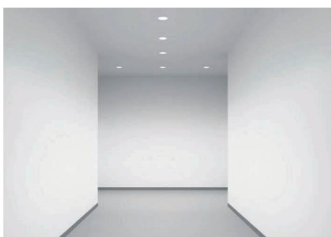
在传统时代，一般由超宽角度的筒灯来实现，但墙壁上边沿光斑过分明显，下部光线不足的情况较难解决；而平射带来的光边沿轮廓又很难模糊的达到相对均匀的状态，因此，平射的照明方式加超广角的滤镜就能较好解决整体均匀的这种状态；
