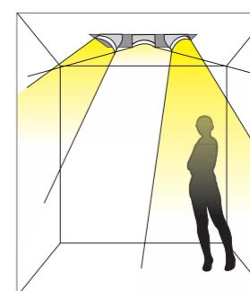
LED 豆胆灯基础照明 / 重点照明 / 壁面照明，一起配合不同的目的，可以自由地设计光源和配光。
